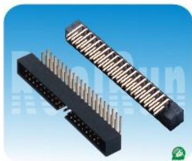
03.4系列: 2.0mm简易牛角,90度 Spec:2.0mm Box Header,Right Angle Positions:6-68 Plastics Height:5.7mm
